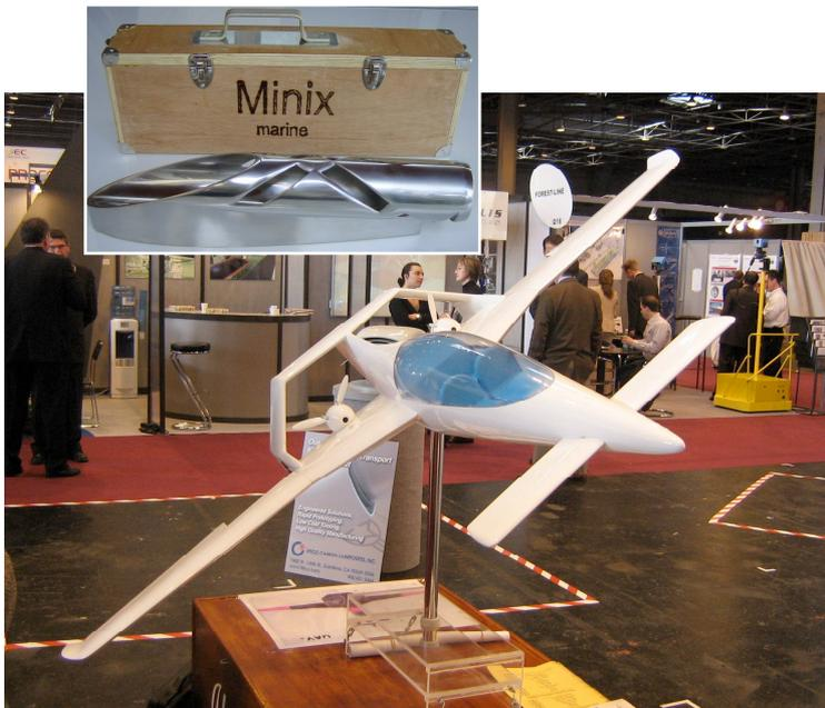
La maquette de l'Ile-de-France présentée au JEC Composite Show en mars dernier montre bien toutes ses caractéristiques aérodynamiques : la grande finesse de la ligne, la voilure canard, le carénage arrière pentagonal, les deux moteurs arrière à hélices tripales implantés au bord de fuite sur l'extrados des ailes. En haut à gauche, la version marine du Minix, le système marine de Christian Hugues étudié avec la DGA.
